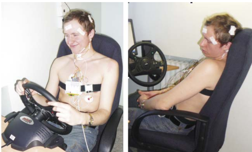
Foto 5. Autojuhtimise simulatsiooni uuringul selgub, kas reaktsiooni aeg ja kiirus on vähenenud; samuti saab uurida, milline on aju bioelektriline aktiivsus, kas vastab see ärkvelolekule või on juba saanud une iseloomulikud tunnused.
